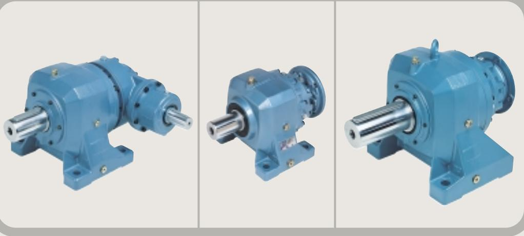
Riduttori con piedini di fissaggio integrati al corpo, in versione coassiale ed ortogonale con albero maschio cilindrico con chiavetta; con coppie in uscita fino a 15.000 Nm. e rapporti da  $i = 3,5$  a 3000. Il particolare corpo del riduttore, garantisce un'elevata robustezza e rigidità, rendendolo un'ottima scelta per un vasto campo applicativo, in particolare per impianti industriali. Disponibile sino alla grandezza 150.
